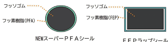
フッ素樹脂被覆ガスケットの断面
